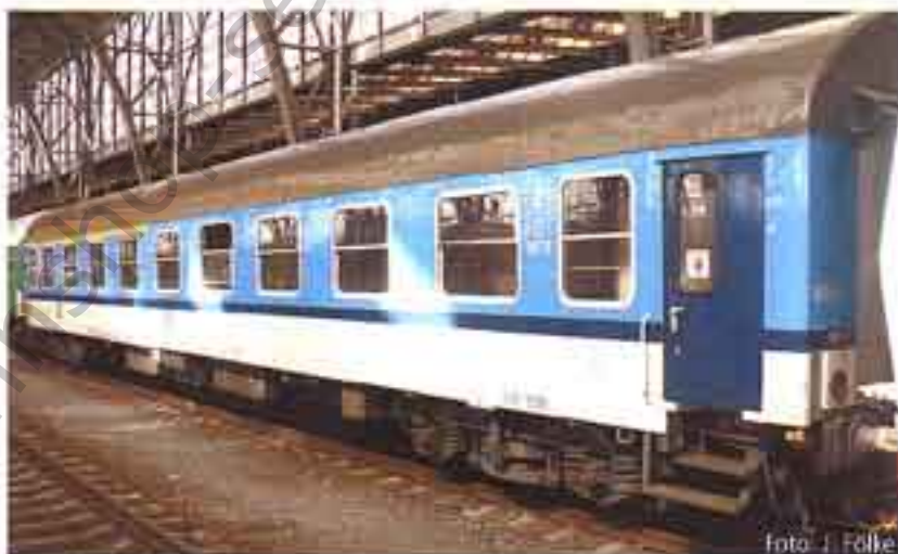
Reisezugwagen 1./2. Klasse, Typ Y/B 70, der ČD, in aktueller Farbgebung 1st/2nd class passenger coach, type Y/B 70, of the ČD, in actual livery
