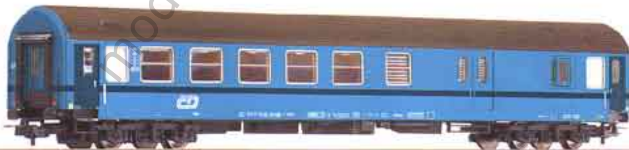
Reisezugwagen 2. Klasse, Typ Y/B 70, der ČD mit Gepäckabteil, in aktueller Farbgebung 2nd class passenger coach, type Y/B 70, of the ČD with baggage compartment, in actual livery
