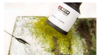
Durch die elektrostatische Aufladung stehen die Grasfasern senkrecht im Leimbett.
