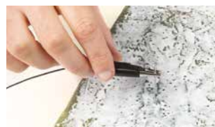
Die Krokodilklemme (Gegenpol) wird in der Nähe der zu begrasenden Fläche befestigt.
