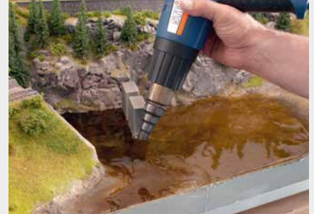
Dank des niedrigen Schmelzpunktes der Water-Drops®, kann das Material mit einem Haartrockner angeschmolzen und nachbearbeitet werden.
