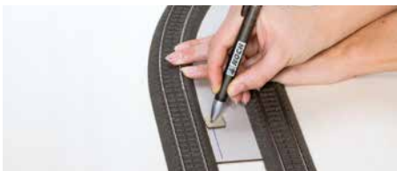
Gleise auf Bauteil auflegen und Kontur übertragen, ...
